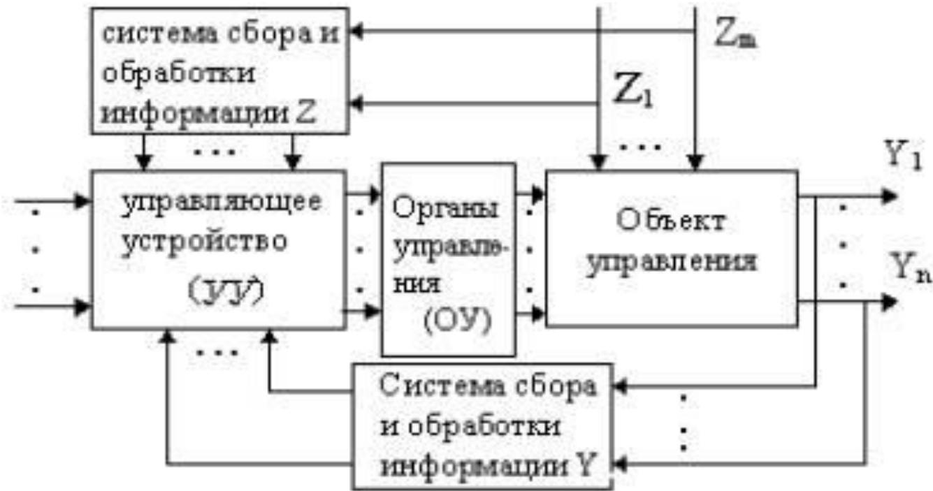
Основными элементами системы автоматического регулирования являются *объект* и *регулирующее устройство*.
