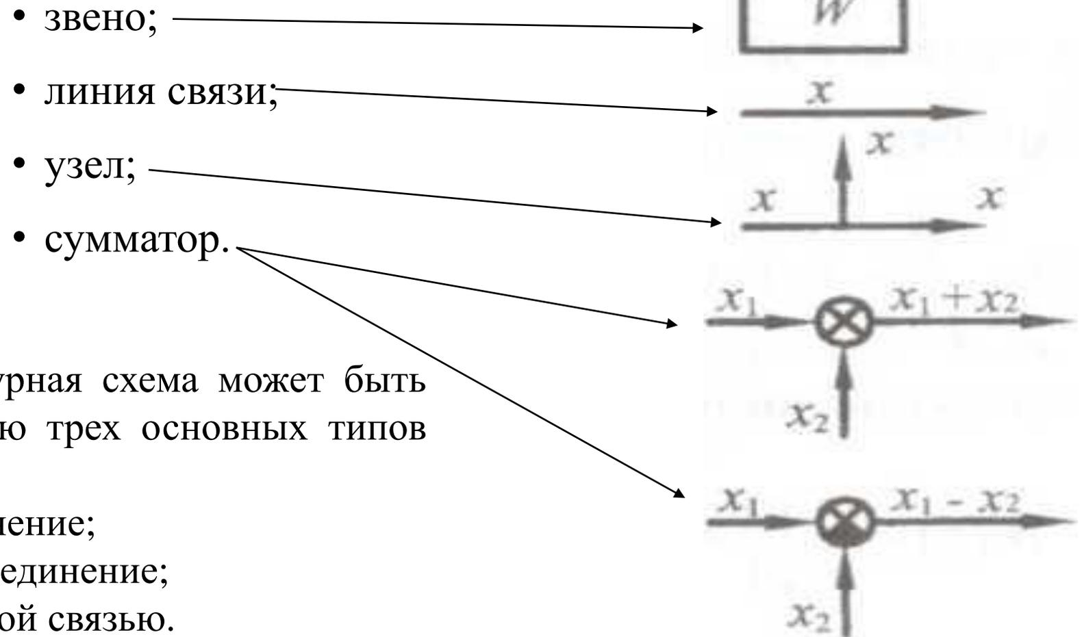
Любая сложная структурная схема может быть изображена с помощью трех основных типов соединений:
