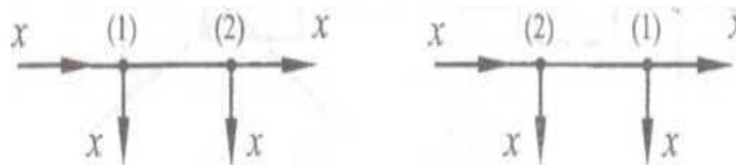
2. Перенос сумматора через сумматор также производится без дополнительных преобразований:
