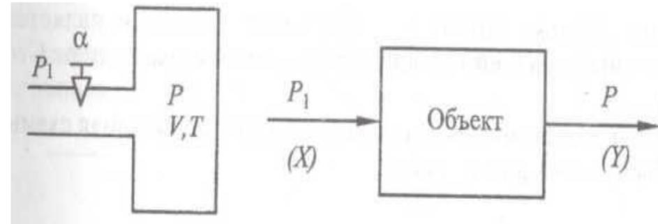
Основной элемент здесь камера с объемом  $V$  и дроссель на входе в камеру с коэффициентом проводимости  $\alpha$ .
