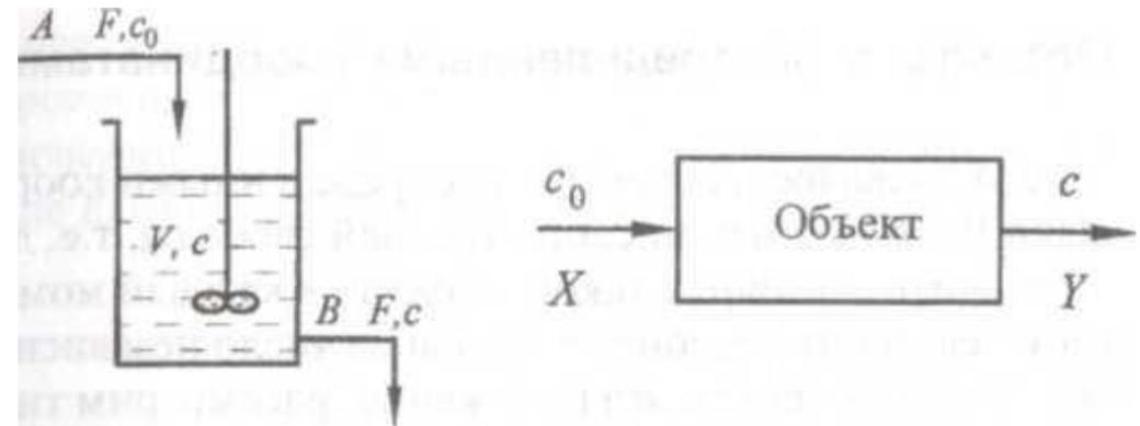
Принципиальная и структурная схемы химического реактора
