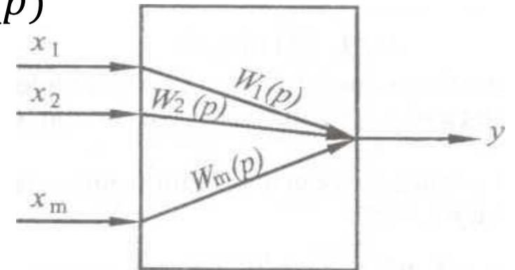
Структурная схема многоканального объекта
