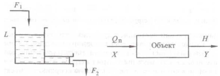
Принципиальная и структурная схемы гидравлической емкости
