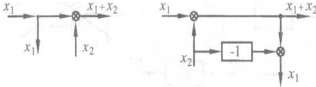
4. При переносе сумматора через узел (по направлению сигнала) в боковой ветви также появляется дополнительное звено с передаточной функцией  $+1$ .
