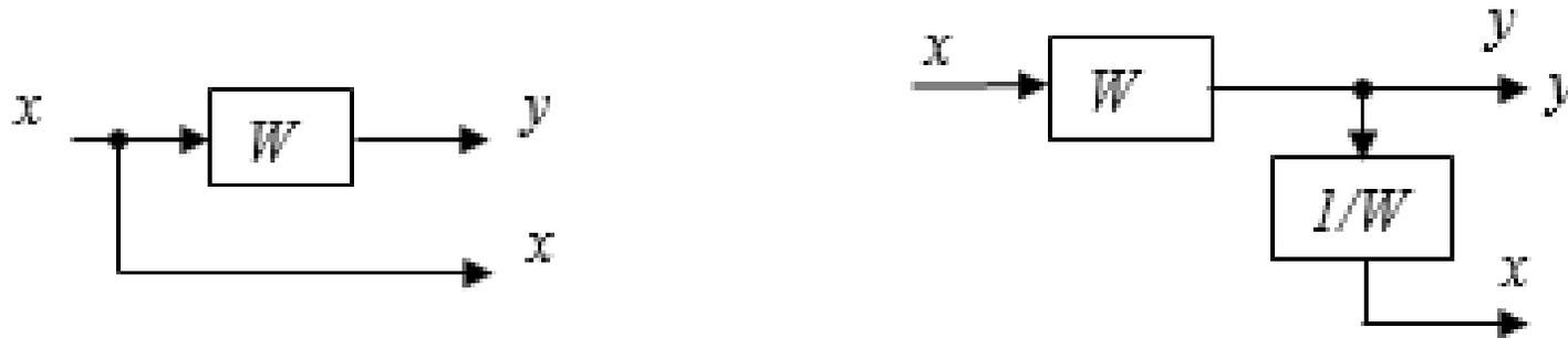
6. При переносе звена через узел (по направлению сигнала) появляется дополнительное звено с передаточной функцией  $W$ .
