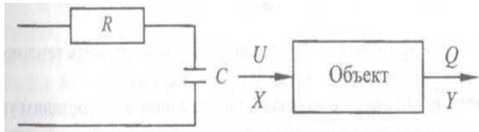
Выходной координатой этого объекта может быть выбран заряд  $Q$  на обкладках конденсатора, а входной – напряжение на входе цепи  $U$ . Дифференциальное уравнение получается на основе закона Кирхгофа:
