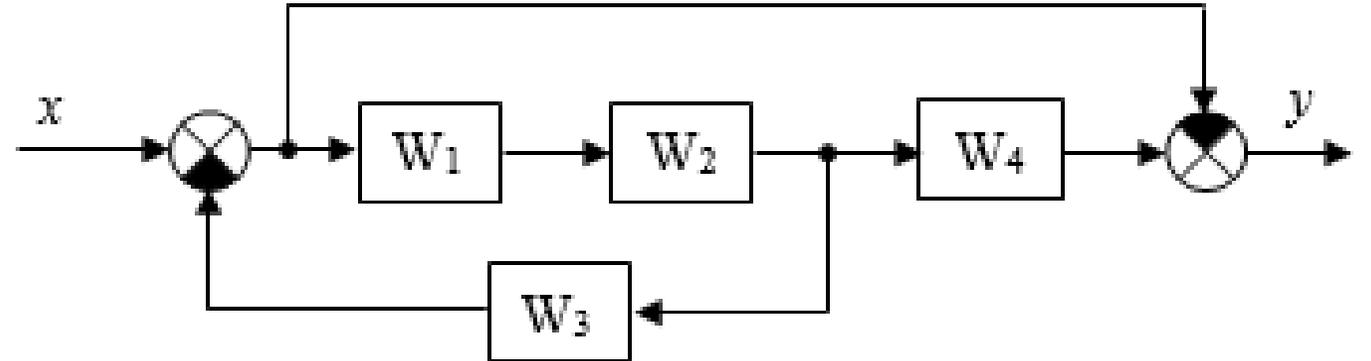
Требуется получить эквивалентную передаточную функцию  $W_{xy}$ .
