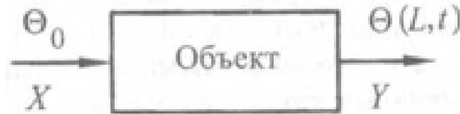
Жидкость, проходя внутри трубы, изменяет свою температуру от начального значения (0) до конечного ( $L$ ), чтобы определить состояние объекта, необходимо задать температуру жидкости в каждый момент времени в каждом сечении  $l$ , получаем дифференциальные уравнения динамики в частных производных.
