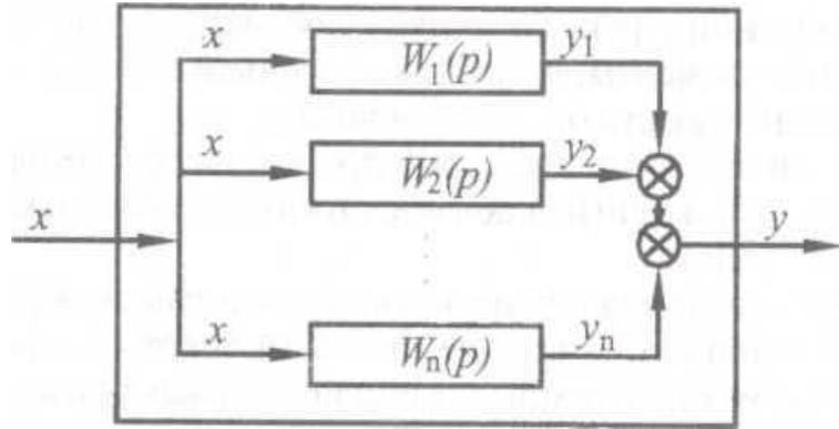
Структурная схема системы с параллельным соединением звеньев
