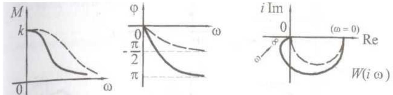
Кривая разгона и ИПФ апериодического звена второго порядка
