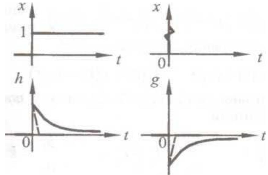
Примером звена является «RC»-цепочка, если для нее в качестве входной координаты принять входное напряжение, а за выходную координату – силу тока в цепи.
