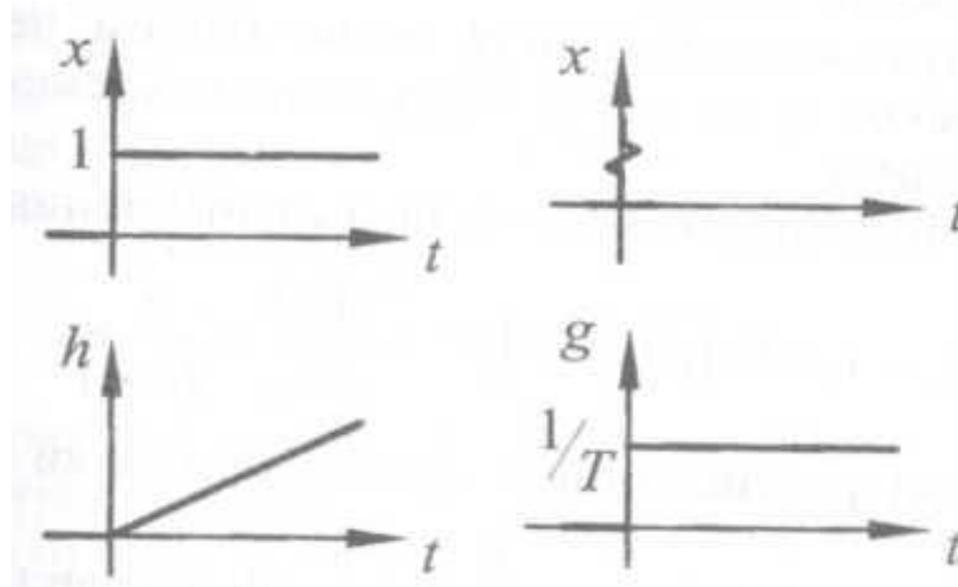
При подаче на вход интегрирующего звена постоянного возмущения выходная координата увеличивается до бесконечности с постоянной скоростью
