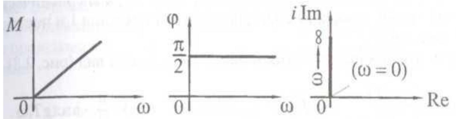
Примеров идеальных дифференцирующих звеньев в природе не существует (амплитудно-частотная характеристика увеличивается до бесконечности с ростом частоты, т.о. при постоянной амплитуде входного гармонического сигнала с увеличением частоты возрастает и амплитуда выходного сигнала).
