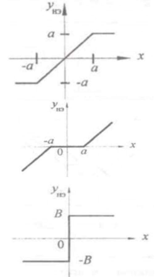
Общими особенностями этих элементов являются однозначность статических характеристик и отсутствие фазового сдвига между входными и выходными колебаниями.
