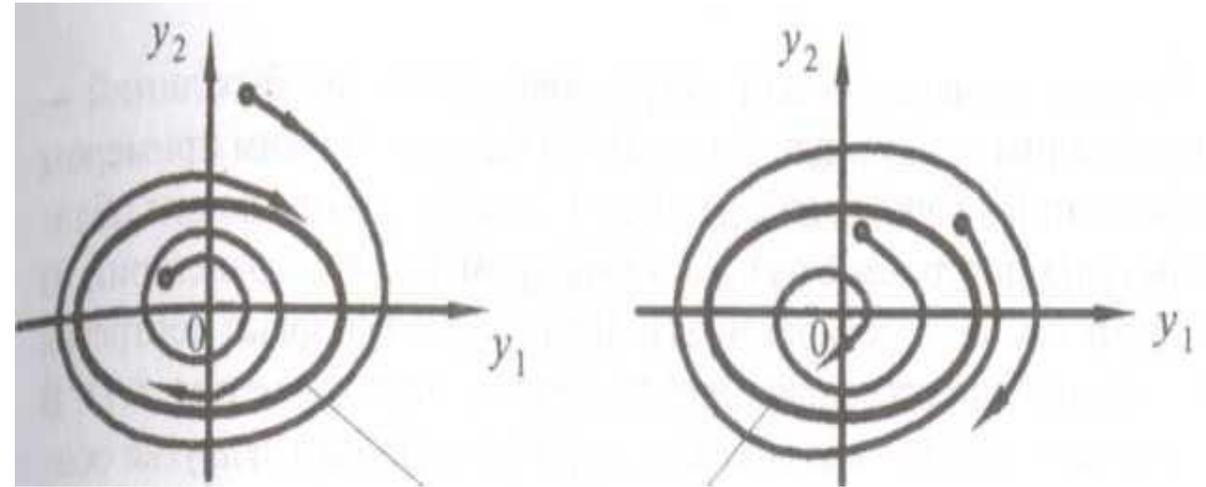
*Предельный цикл* – изолированная замкнутая траектория близкая к состоянию равновесия, к которой фазовые траектории приближаются, скручиваясь от начала координат. К нему же идут траектории, находящиеся снаружи предельного цикла.
