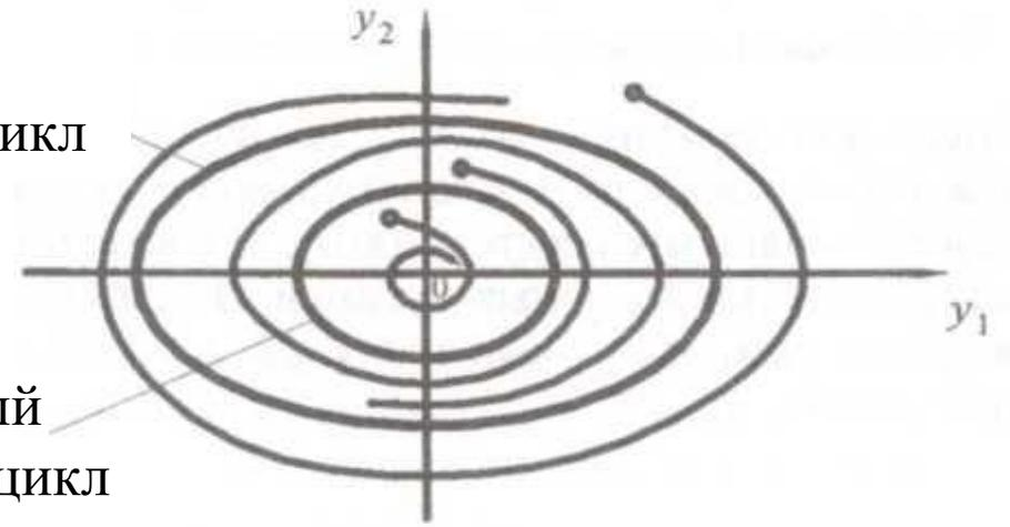
Если изображающая точка находится внутри предельного цикла, то она будет двигаться по фазовой траектории к началу координат, т.е. система ведет себя как устойчивая, приближаясь к состоянию равновесия.
