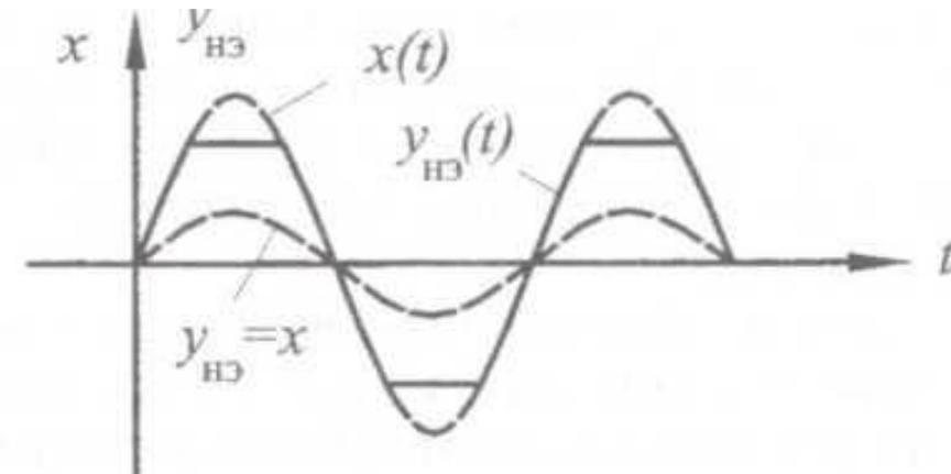
Иллюстрация зависимости частотных характеристик нелинейного элемента от амплитуды входного сигнала
